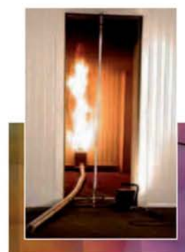
Foto 11. Sistema de ensayo ISO/FDIS 13784-1. Fuente: SP-Swedish National Testing & Research Institute.
